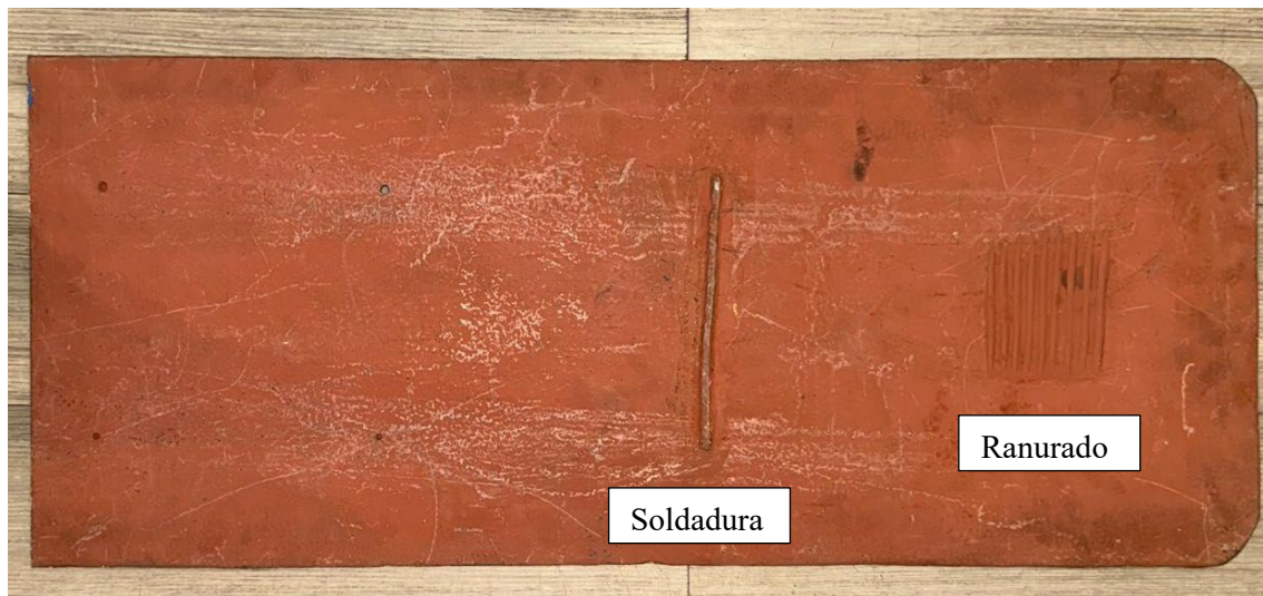
Figura 12: Probeta de acero al carbono de 7,2 mm de espesor nominal, que presenta un cordón de soldadura generando un sobre espesor localizado y ranurados mecanizados destinados a emular pérdida de material por corrosión.
