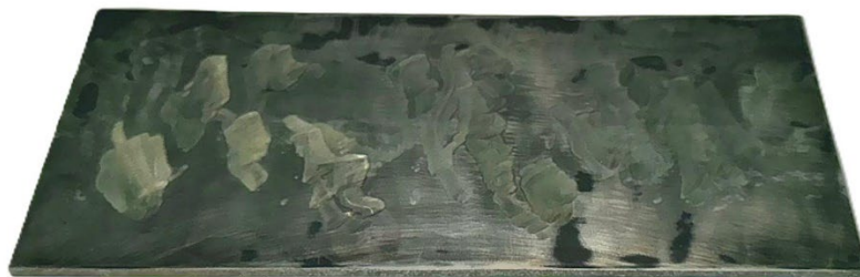
Figura 10: Probeta con defectos volumétricos provocados.
