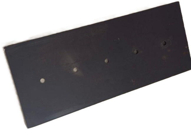
Figura 7: Patrón de referencia “Flat Bottom Holes” (FBH) con agujeros de 6 mm de diámetro mecanizados con electroerosión.
