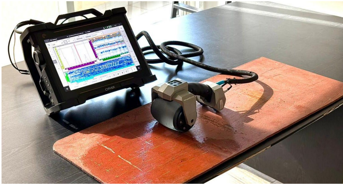
Figura 6: Inspección con equipo portátil de PAUT y transductor “Wheel array” de 10 MHz.
