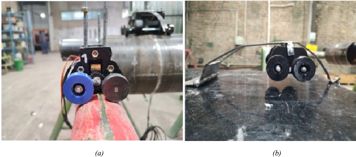
Figura 5: Carros que componen el movimiento circunferencial; (a) Carro principal. (b) Carro accesorio.
