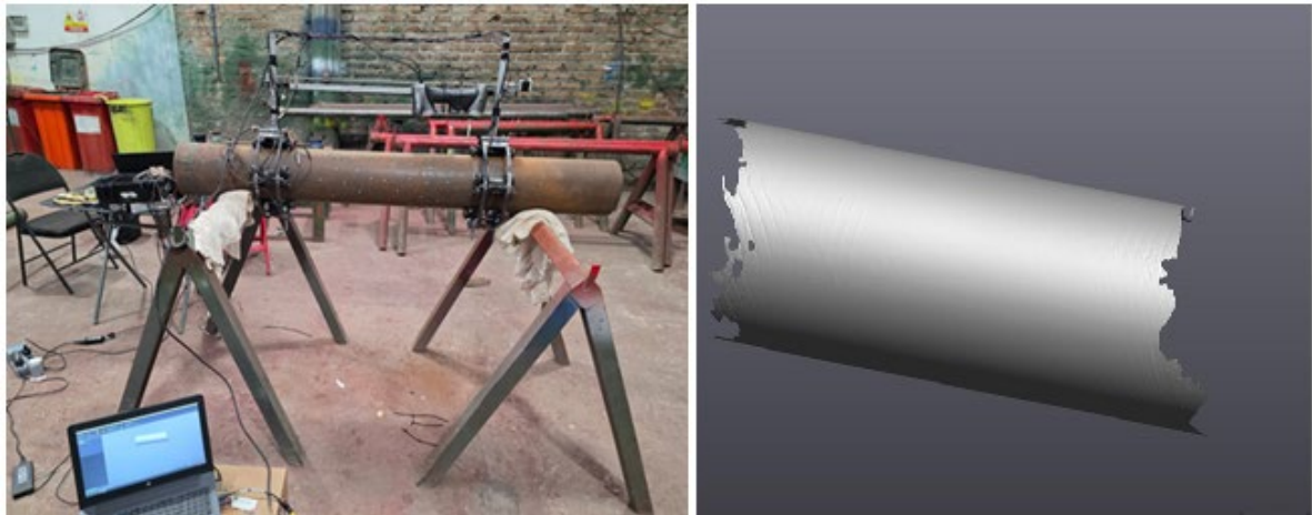
Figura 11: Resultado del escaneo utilizando el prototipo a) Prototipo montado sobre la superficie de la tubería b) Superficie escaneada de la tubería.
