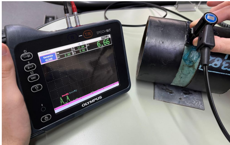
Fig.8: A-Scan correspondiente a un despegue total del revestimiento.
