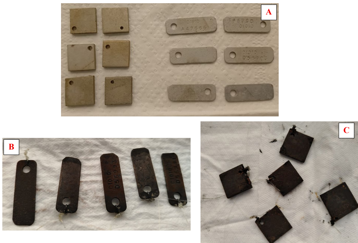
Figura 4. Biopelículas formadas sobre los cupones (colonias sésiles). A: Cupones limpios previo a la formación de biopelículas. B: Cupones del reactor de agua sintética. C: Cupones del reactor de Postgate B.
