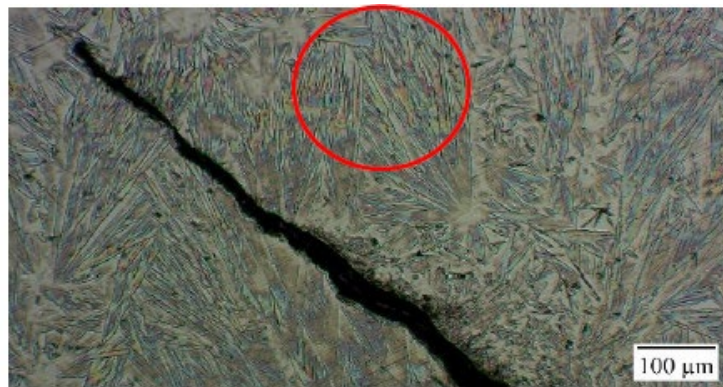
Figura 14. (X200) Microestructuras luego de ataque metalográfico. (a) Microestructura ferrítico-perlítica (b) Martensita asociada a una fisura
