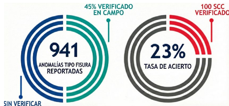
Figura 2 - Indicaciones EMAT y Verificaciones de campo
