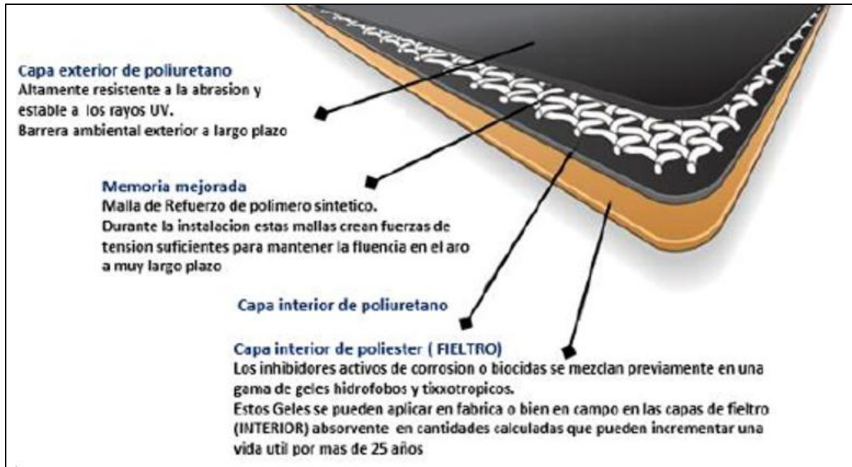
Fig. N° 10 – Chaqueta de cuatro capas que elimina múltiples pasos en la instalación.
