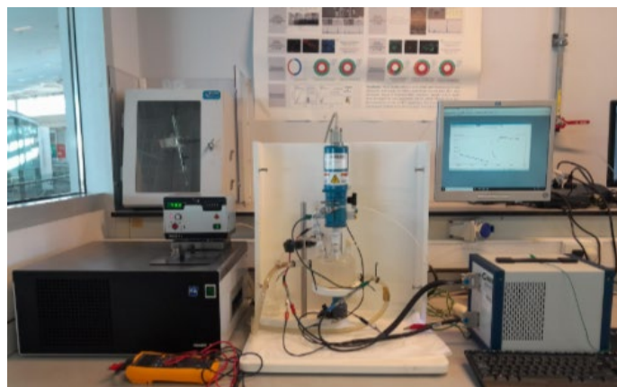
Figura 1. Set up experimental empleado para la determinación de velocidad de corrosión. Los ensayos electroquímicos se realizan en atmósfera de N_2 y control de temperatura.
