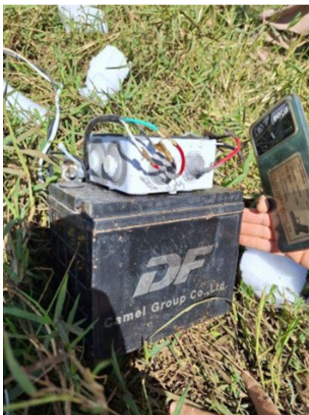
Figura 3: Batería de motocicleta que alimenta el relé
