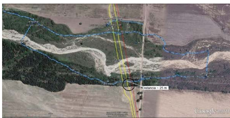
Figura 8. Caso 1 – Curva – Río Jesús María, Córdoba (la línea punteada es la nueva margen erosionada)
