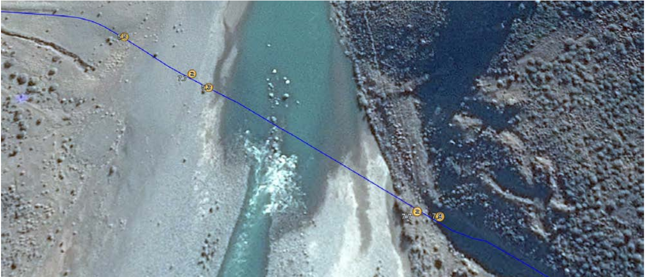
Figura 23. Visualización en GIS de valores de tapadas medidas con el detector junto con la aplicación móvil
