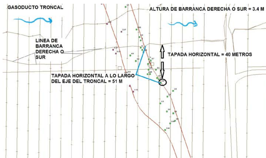
Figura 25. Medición de la distancia horizontal en donde la tapada vertical iguala a la altura de la barranca
